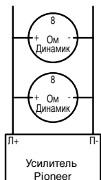
Мостовое соединение 4 Ом
